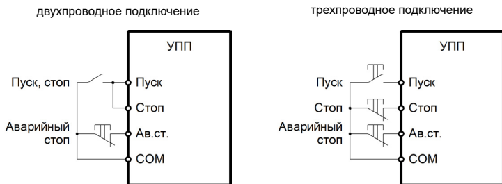
Рисунок 5 – Трехпроводная и двухпроводная схема управления
